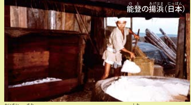
能登の揚浜(日本) 海水を砂にまき、こくしてからにつめ、塩をつくります。
